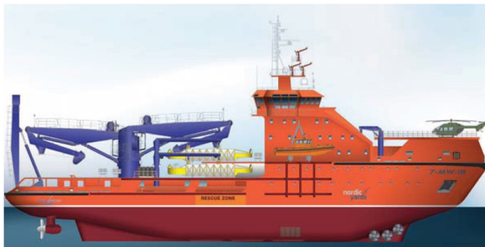
Modellzeichnung für die beiden je 86 Meter langen und 19 Meter breiten, eisbrechenden Rettungsschiffe, die Russland bei Nordic Yards bestellt hat. Grafik Nordic Yards
